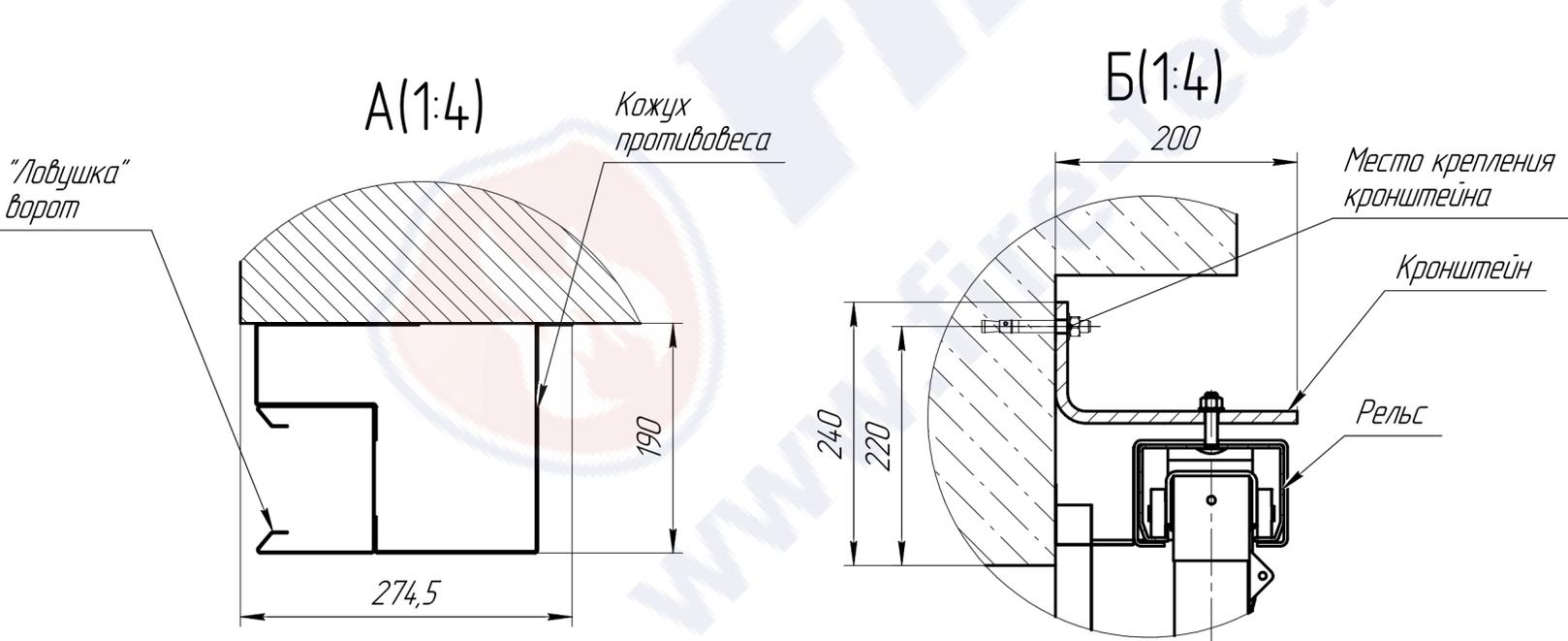
1. Металлоконструкция (или бетон) должна быть выполнена в единой плоскости "X". Допустимое отклонение по вертикали от плоскости "X"  $\pm 5$ мм на всем размере конструкции. Допустимое отклонение в местах сварных соединений  $\pm 5$ мм.
